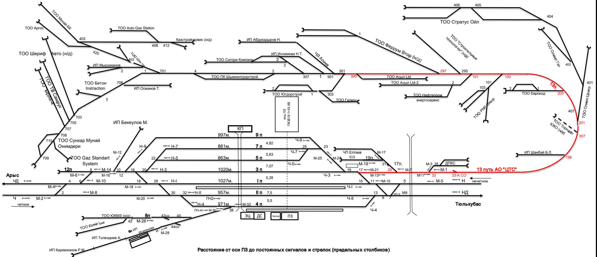
**Расстояние от оси ПЗ до постоянных сигналов и стрелок (предельных столбиков)**
